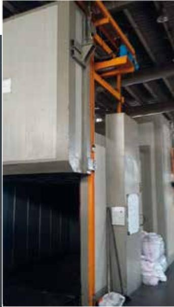
Печи для термической обработки алюминия - это печи, предназначенные для закалки, другими словами, для увеличения прочности алюминиевых профилей. Целью термической обработки алюминия в печах является отверждение пористых структур при температуре 180-200 °C на протяжении определенного времени (6-8 часов).
