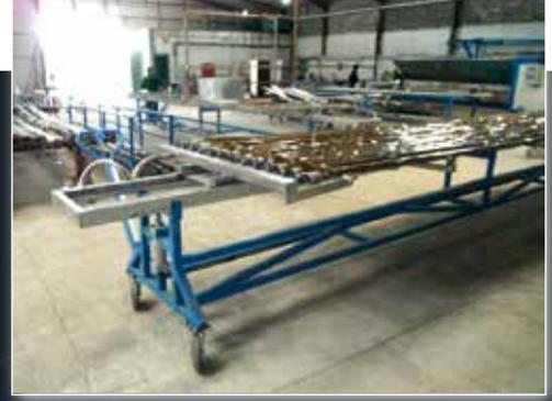
Ahşap desen ile kaplanma işlemleri transfer kağıtları ile kaplanacak alüminyumun uygun sıcaklıkta fırınlanma işleminden sonra transfer kağıdındaki desenlerin alüminyum profile aktarılması ile hazırlanmaktadır. Transfer kağıdı atmosferik basınç ve çevre etkenlerine dayanıklıdır. Alüminyum ahşap transfer işlemleri sırasında çevreye zarar verilmemektedir.
